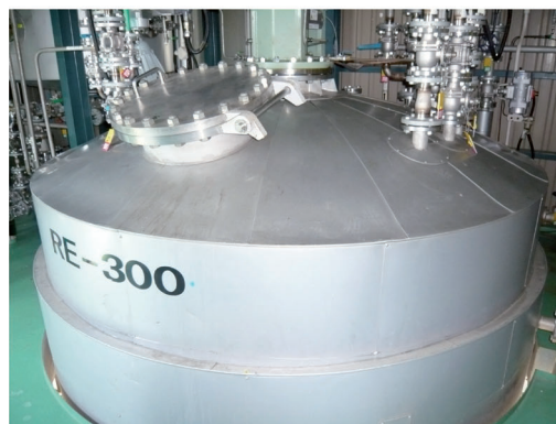
Abbildung 3. Mentholproduktion bei der Takasago Iwata Factory, Shizuoka. Oben: Destillationstürme zur Reinigung von Geranyldiethylamin bei einer Besichtigung durch R. Noyori (unten links) 1984. Unten: Der heutige (2012) Reaktor für die asymmetrische 1,3-Wasserstoffverschiebung. Mit freundlicher Genehmigung der Takasago International Corporation.
